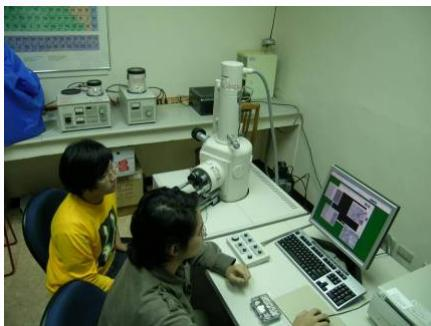
S3000N掃描式電子顯微鏡
